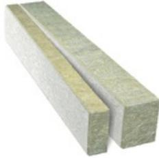
Ламель PAROC CGL 20су - это негорючая каменная вата, для утепления потолков существующих и строящихся зданий. Прочность на сжатие при 10 % деформации – 20 кПа. Ламель обладает превосходными щелочестойкими характеристиками. Она не накапливает влагу и не теряет своих свойств при изменении температуры.
